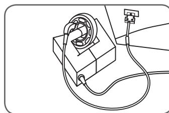
C Se si utilizza la modalità di funzionamento in base alla temperatura, collegare la sonda al riscaldatore, preferibilmente alla parte più calda del componente che solitamente è quella più vicina al morsetto. In caso di riscaldamento di un cuscinetto, collegare **sempre** la sonda all'anello interno.
