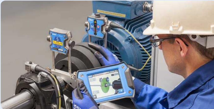
几乎每一个行业都需要轴对中，因为它可以大大地延长机器的运行时间，并减少维护成本。TKSA 41简单易用，让您对在处理所有类型的水平旋转机的对中任务中有更大的信心。
