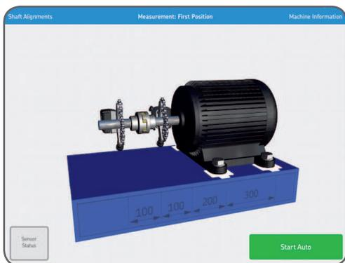
当系统检测到轴已经被充分地旋转了，并且短时间内没有动过，它将自动记录第2<sup>nd</sup>次测量位置。
