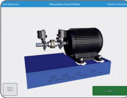
当系统察觉到轴已经再次被足够地旋转了，并且短时间内没有动过，它将自动记录第3<sup>rd</sup>次测量位置。
