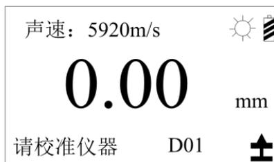
**耦合状态：**探头与被测工件的耦合状态
