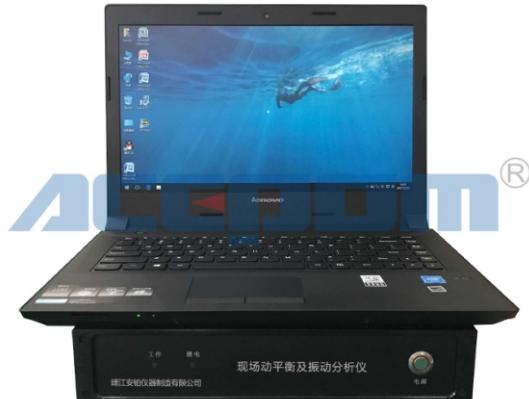
现场动平衡仪及振动分析仪ACEPOM325可利用现场动平衡技术利用很短的时间解决设备转子或轴系动平衡不良的故障，从而大大节省拆卸、运输、安装、维修的费用，进而为企业带来明显的经济效益。
